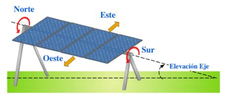
Descripción de los parámetros para la definición de un sistema a un eje. Diagrama adaptado de [2].
