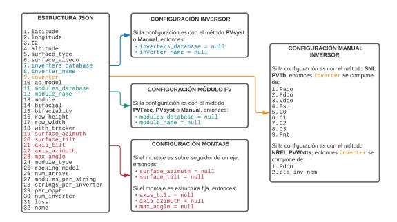
Estructura archivo de configuración JSON para modelar una planta solar fotovoltaica.
