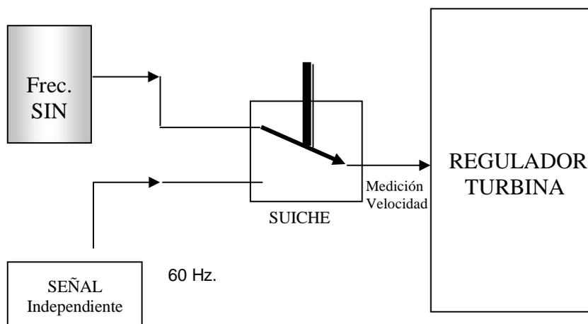
Figura 7. Esquema prueba protocolo de banda muerta A – Generador Externo
