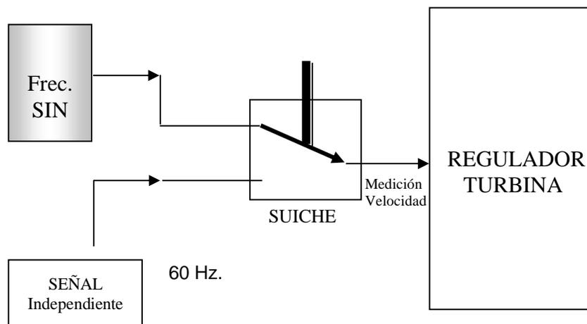
Figura 3. Esquema prueba protocolo de estadismo A – Generador Externo
