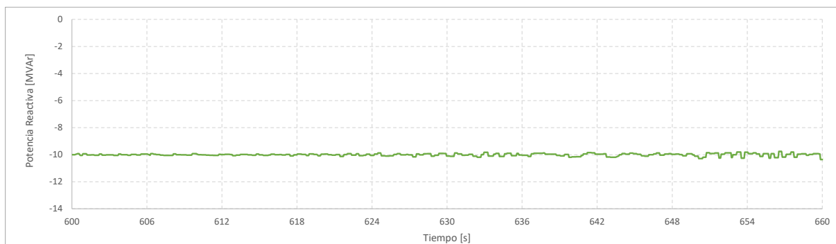
Gráfico 12. Registro de potencia activa y potencia reactiva. PQ 10. Control Q
