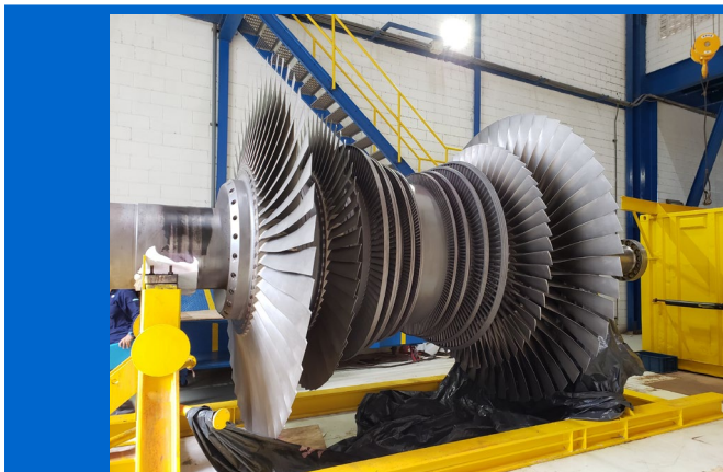
Rotor de Turbina. Sección LP
