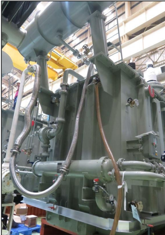
Fabricación de transformadores etapa II Montaje final en fábrica transformador 14
