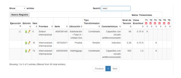
La tabla presenta la información registrada del Plan de Pruebas cargado (Item, Frontera, Serie, Ubicación, Tipo Transformador, Características, Nivel de Tensión, Clase de Exactitud y las Metas Trimestrales 1 a la 6, y la marca con X del trimestre en el que se planea realizar la prueba del transformador).
