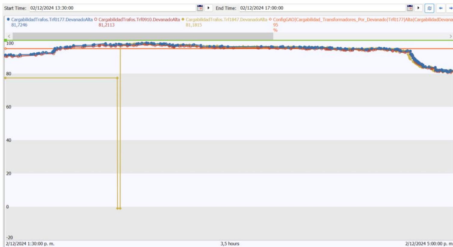
Cargabilidades [%] de los devanados de alta tensión de los Transformadores Tebsa 1, 2 y 5 100 MVA 220/110/13.8 kV
