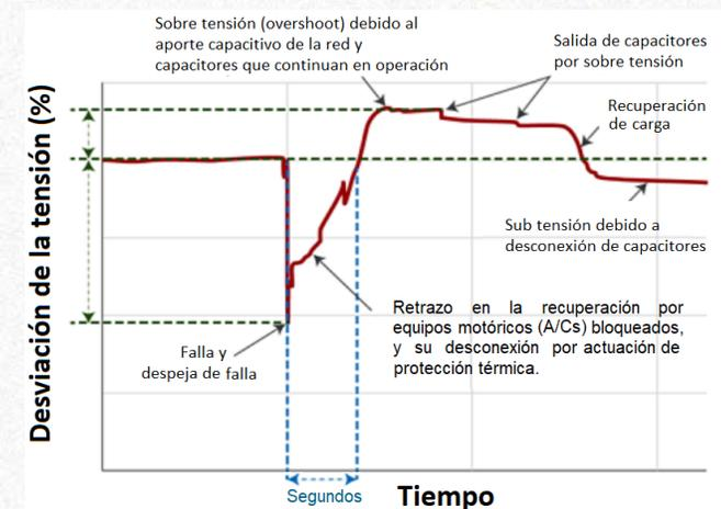
**Condición de emergencia nodos en configuración radial del área Caribe**
