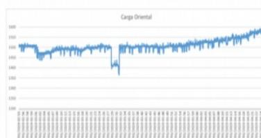
03:29 horas, ocurre disminución súbita de carga en Oriental, aproximadamente 100 MW, sin apertura de interruptores adicionales en el STR o STN.
